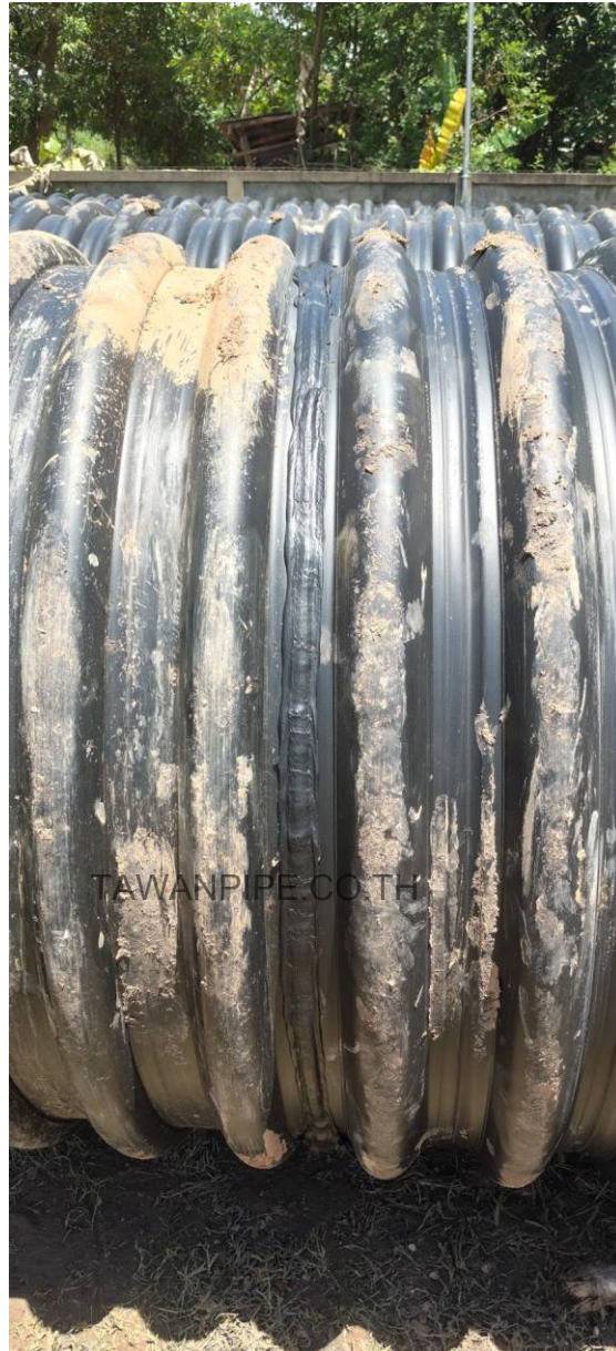
ภาพที่ 12 ตัวอย่างลักษณะแนวเชื่อมภายนอกหลังการปฏิบัติงาน ควรทำความสะอาดผิวก่อนการตรวจเพื่อให้สามารถประเมินความต่อเนื่องของแนวได้
