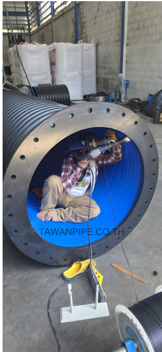
ภาพที่ 15 การเชื่อมและเก็บรายละเอียดภายในชิ้นงานท่อหน้าแปลนขนาดใหญ่
